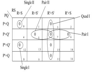
F(P,Q,R,S) = (P+Q+R+S).(P'+Q'+R+S).(P+Q'+R').(P+Q'+S').(R'+S')
